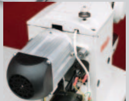
Der leistungsstarke Servo-Motor ist am Oberteil angeflanscht und sorgt für einen ruhigen Lauf.
